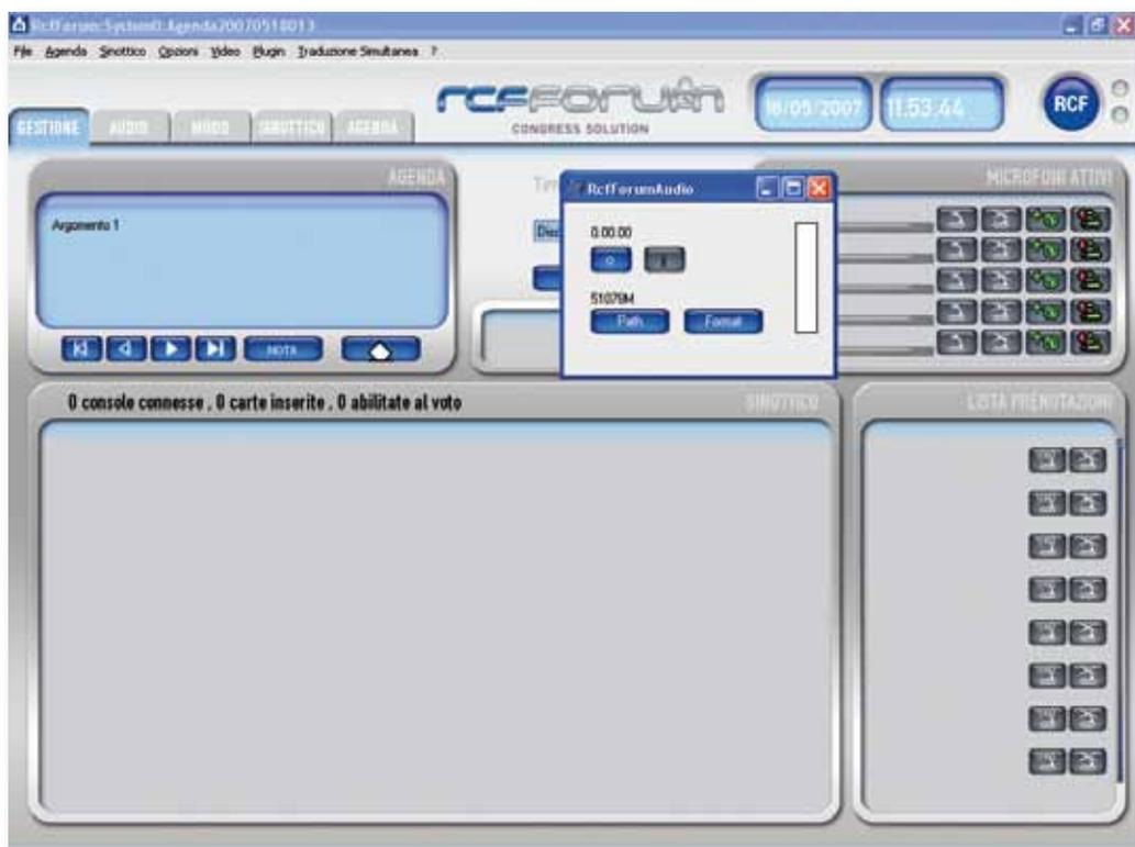
Durch Drücken der Taste „Path“ wird der Defaultverlauf visualisiert, in dem das File Audio gespeichert wird, mit der Möglichkeit des Wechsels.
