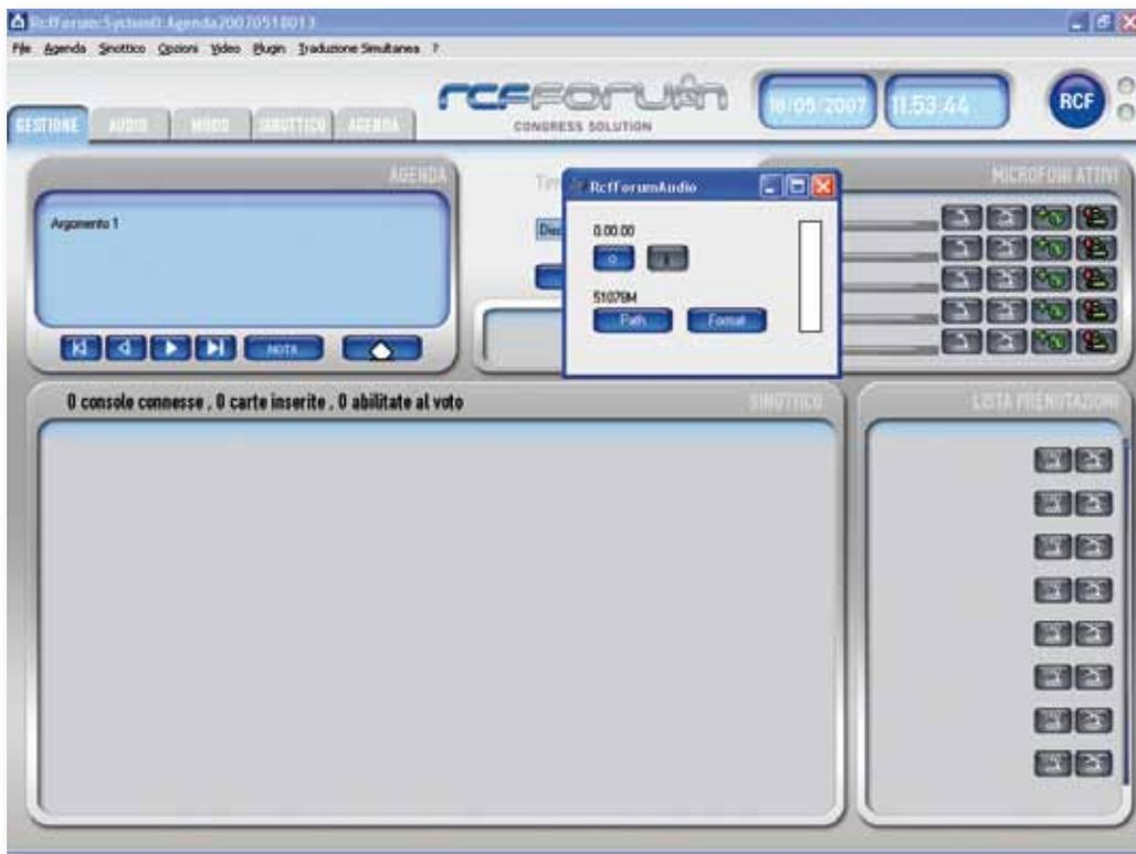
Premendo il tasto "Path" viene visualizzato il percorso di default nel quale viene salvato il file audio, con possibilità di cambiarlo.
