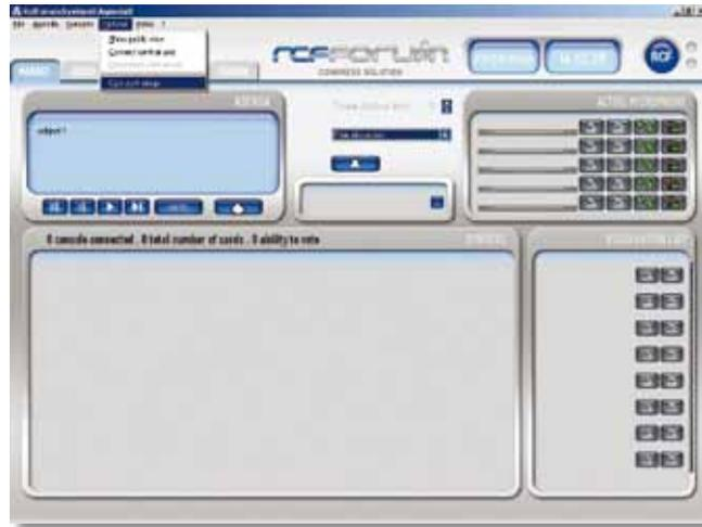
Um den Computer an die Zentrale anzuschließen, gehen Sie auf das Menü „Optionen“ und wählen Sie „Kommunikationseinstellungen“ aus. Um die Änderungen betriebsbereit zu machen wird die genutzte Kommunikationsschnittstelle angesetzt, indem die Nummer der genutzten Schnittstelle „Com-Port“ eingegeben und anschließend bestätigt wird. Dann im Menü „Optionen“ „Zentrale Verknüpfungen“ auswählen. Wird die Zentrale zum ersten Mal verknüpft, öffnet sich das folgende Fenster.
